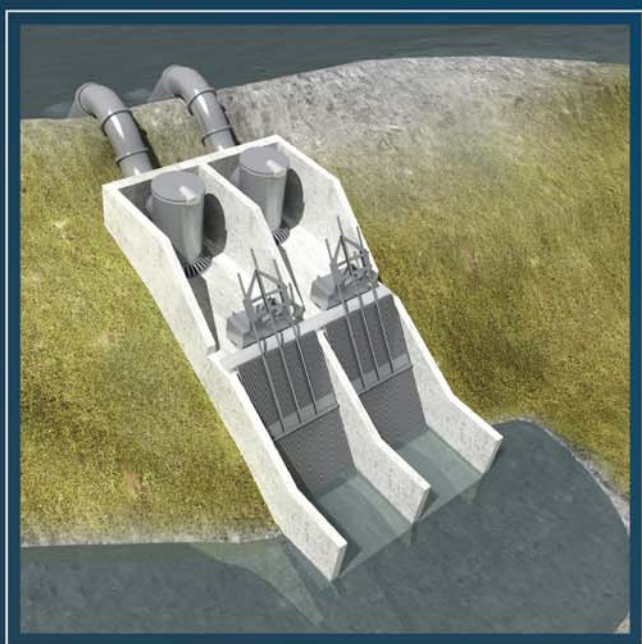
Насосная станция для ливнёвых стоков
